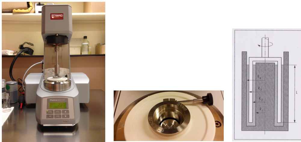
Abbildung 3: Doppelspalt-Zylinder-Geometrie am Rheometer sowie grafische Darstellung des Messvorganges. Abteilung für Biomedizinische Forschung, MedUni Wien. Bilder: Bianca Serp. Grafik modifiziert nach 12
